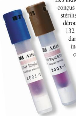
Les indicateurs biologiques 1291 Attest 3M, conçus pour la vérification des cycles de stérilisation à la vapeur par gravité qui se déroulent à une température de 132 °C (270 °F), fournissent des résultats dans un délai d'une heure. Quant aux indicateurs biologiques 1292 Attest 3M, conçus pour la vérification des cycles de stérilisation à la vapeur assistée par dépression qui se déroulent à une température de 121 °C (250 °F), ils fournissent des résultats dans un délai de trois heures.
